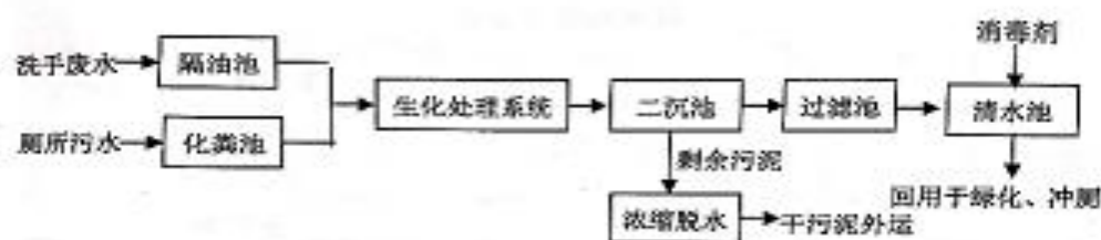
图 4-1 近期污水处理工艺流程图（建议）
