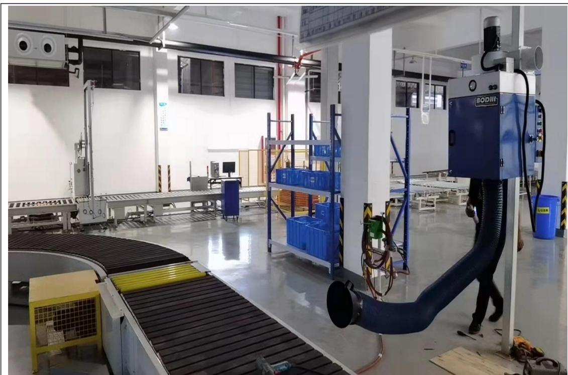
壁挂式焊烟净化器
