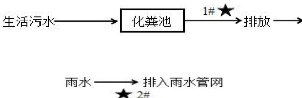
图 6-1 废水监测点位示意图
