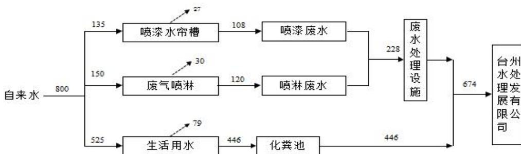
图 2-1 项目用水平衡图
